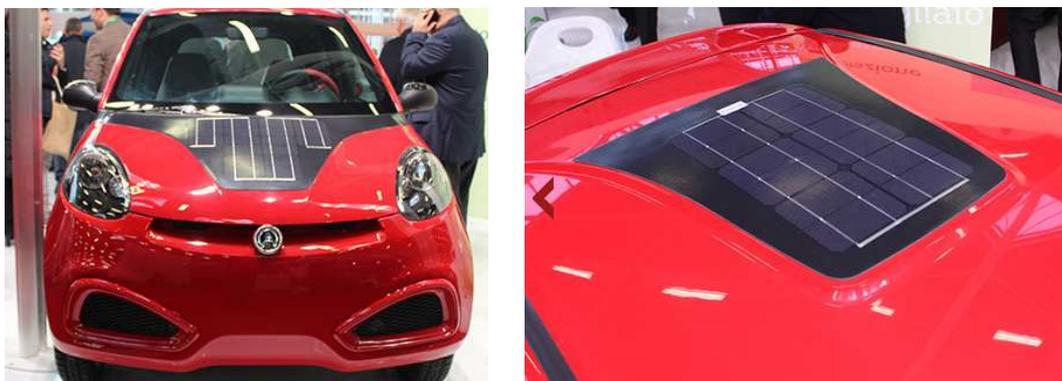
Fig. 6.4 – Foto della i.Car0. particolare anteriore e del tetto munito di pannelli fotovoltaici.
